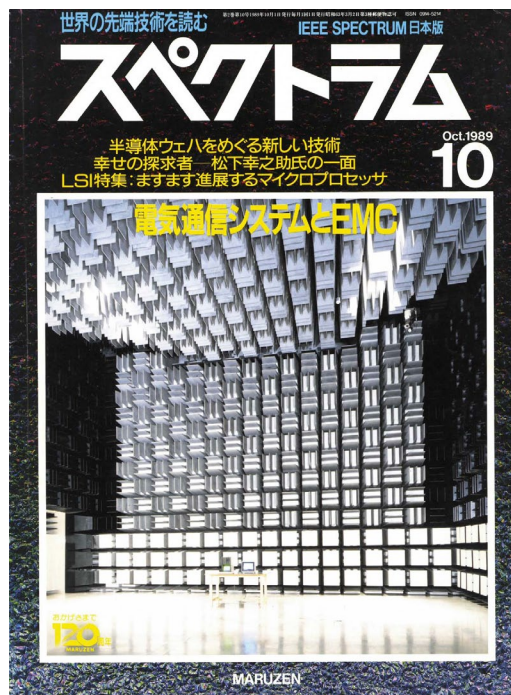
図6 雑誌「スペクトラム」の表紙に掲載された大型電波無響室の内部写真 16)
